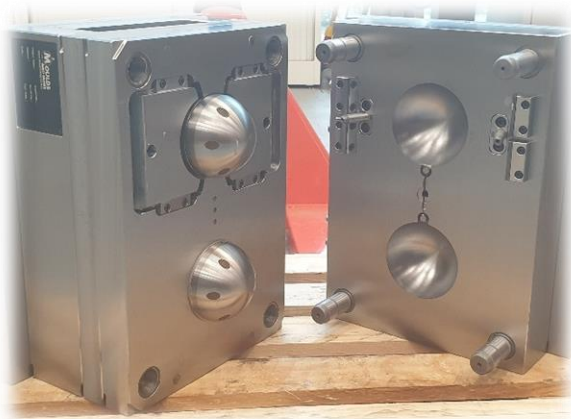
Afbeelding 2: spuitgietmatrijs met kerstbalvorm. Links de achter-matrijs en rechts de voor-matrijs
