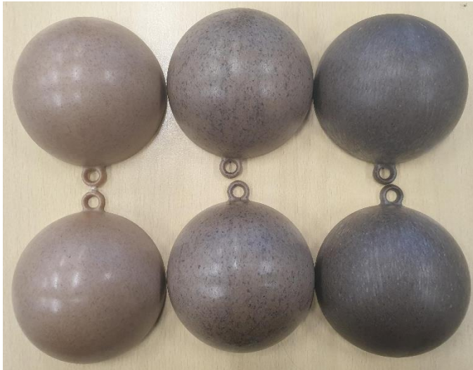
Foto 12: Kerstballen gemaakt van VibersBP; links zonder sparrennaalden, midden met 1% naalden en rechts gemaakt met compound
