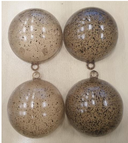
Foto 8: links PLA + 0,5% sparrennaalden; rechts PLA + 4% sparrennaalden
