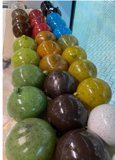
Foto 13: Prototypes gemaakt tijdens de trials van PLA, Diverse kleuren en sparrennaalden
