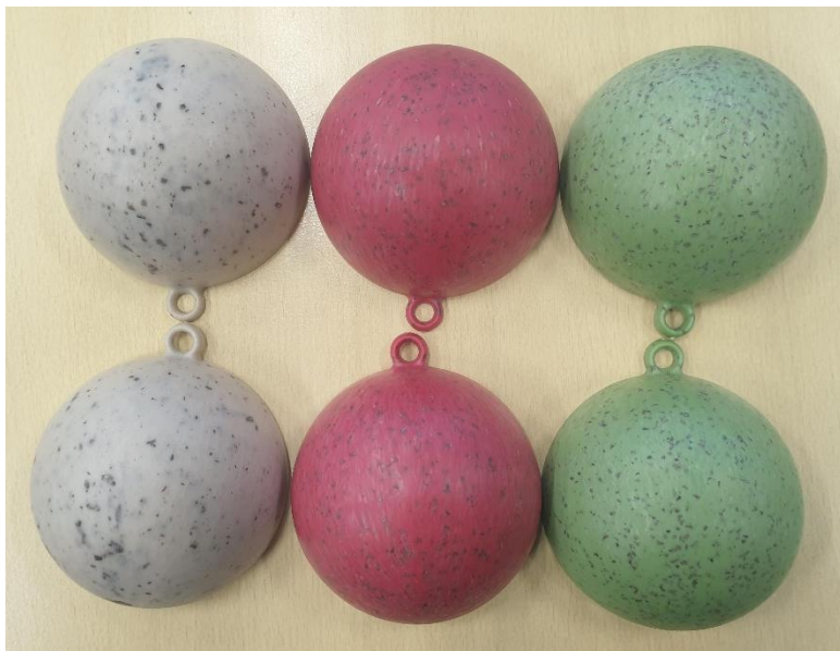
Foto 7: Kerstbal prototypes gemaakt van Solanyl in 3 kleuren
