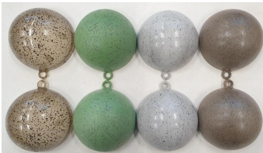
Foto 15: Top 4 kerstballen uit de voorselectie, van links naar rechts: PLA (1% vezel, geen MB), Solanyl (groen MB + 4% vezel), bioHDPE (wit MB + 4% vezel) en VibersBP (4% vezel, geen MB)
