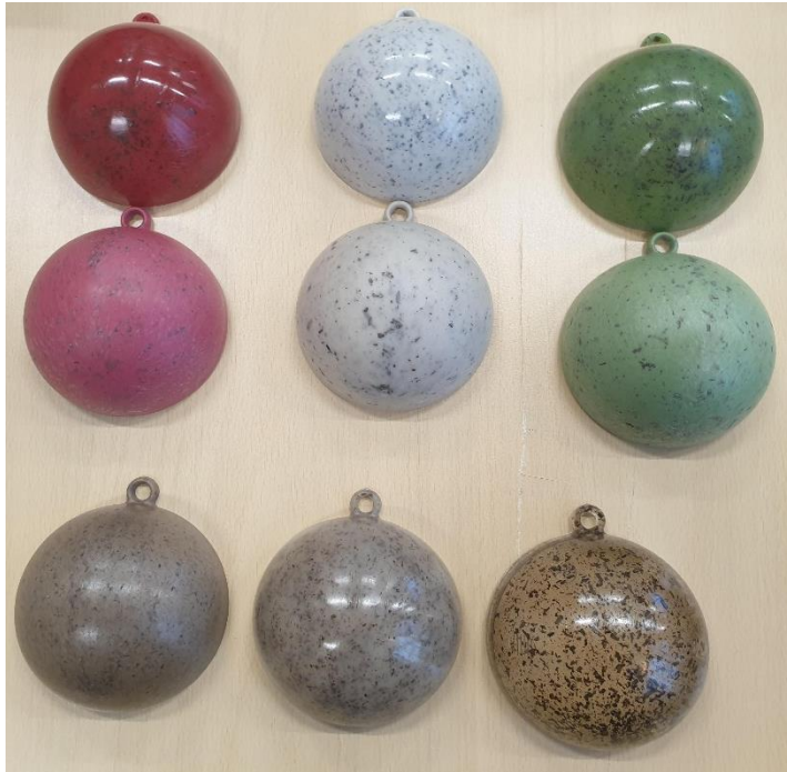
Foto 14: Voorselectie Kerstballen; bovenste rij PLA in 3 kleuren, middelste rij Solanyl in 3 kleuren; onderste rij Vibers, PE en PLA (kleurloos)
