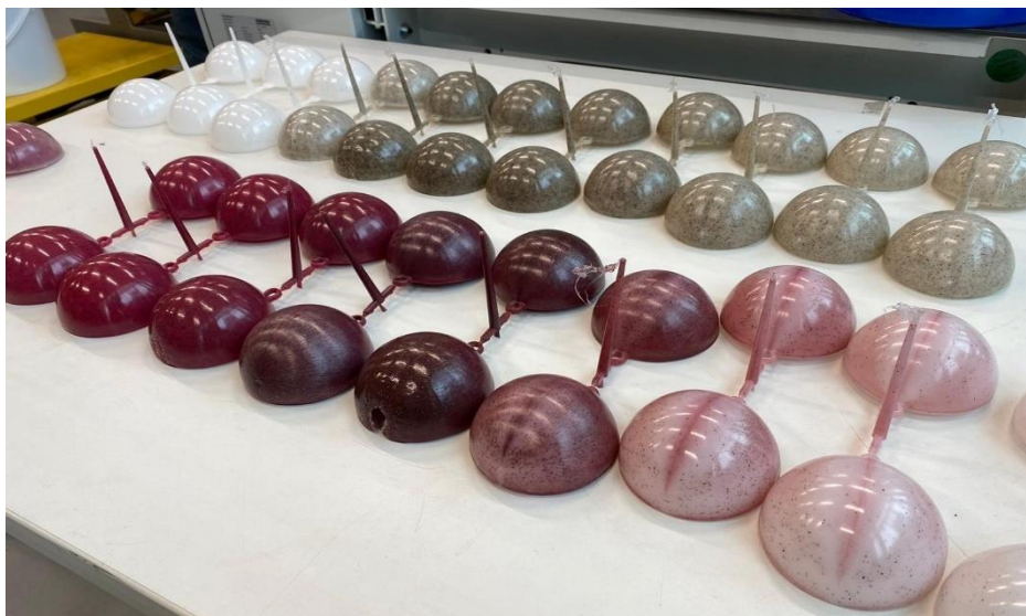
Foto 6: Eerste batch kerstballen gemaakt van bio-HDPE, 1% kleurmastbatch en 4% sparrennaalden.
